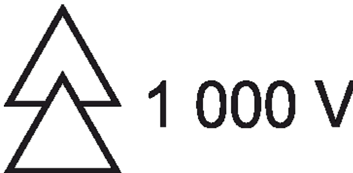
Figure 1 – Marquage de la limite électrique de travail adjacent au symbole double triangle (IEC 60417-5216:2002-10)
